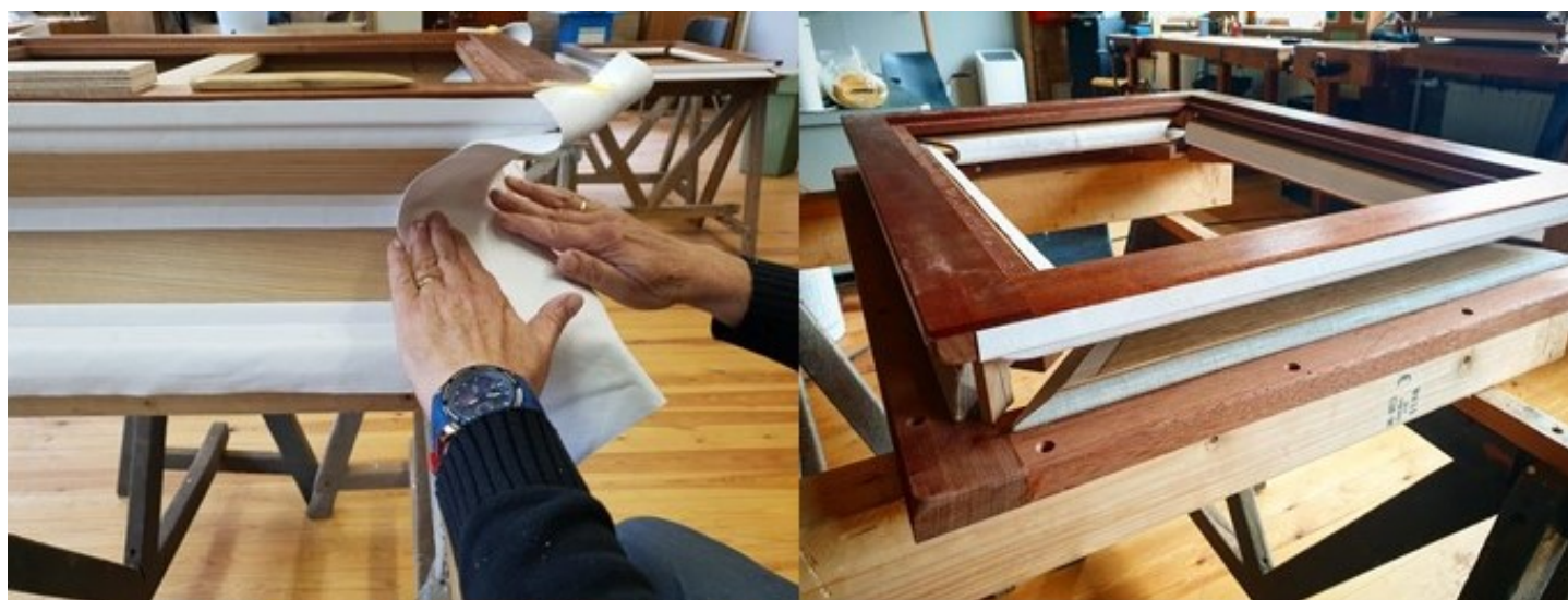
Image : R novation des soufflets par Van den Heuvel
